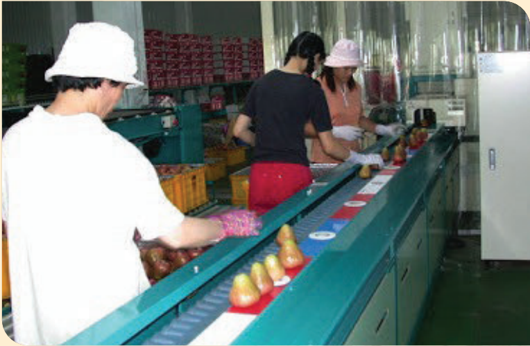
蓮霧光波分級機設備及目前使用情況
